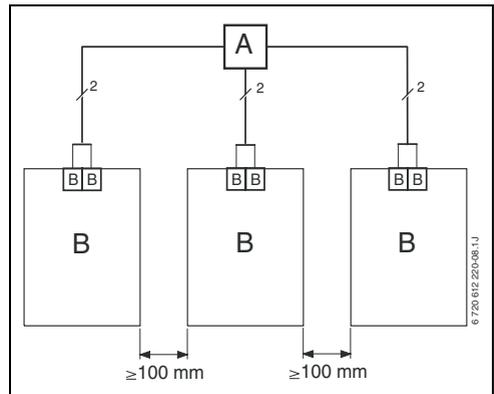
Bild 10 Anschluss der BUS-Verbindungen über Abzweigdose (A)
