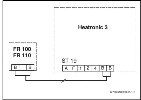
Bild 9 Regler an der BUS-fähigen Heatronic 3 angeschlossen.
